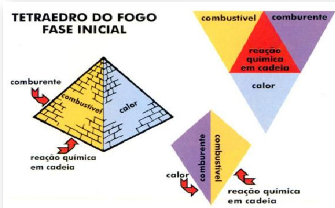
O **Combustível** em contato com uma fonte de **Calor** e em presença de um **Comburente** (geralmente o oxigênio contido no ar) começará inflamar gerando a **Reação em cadeia**.
